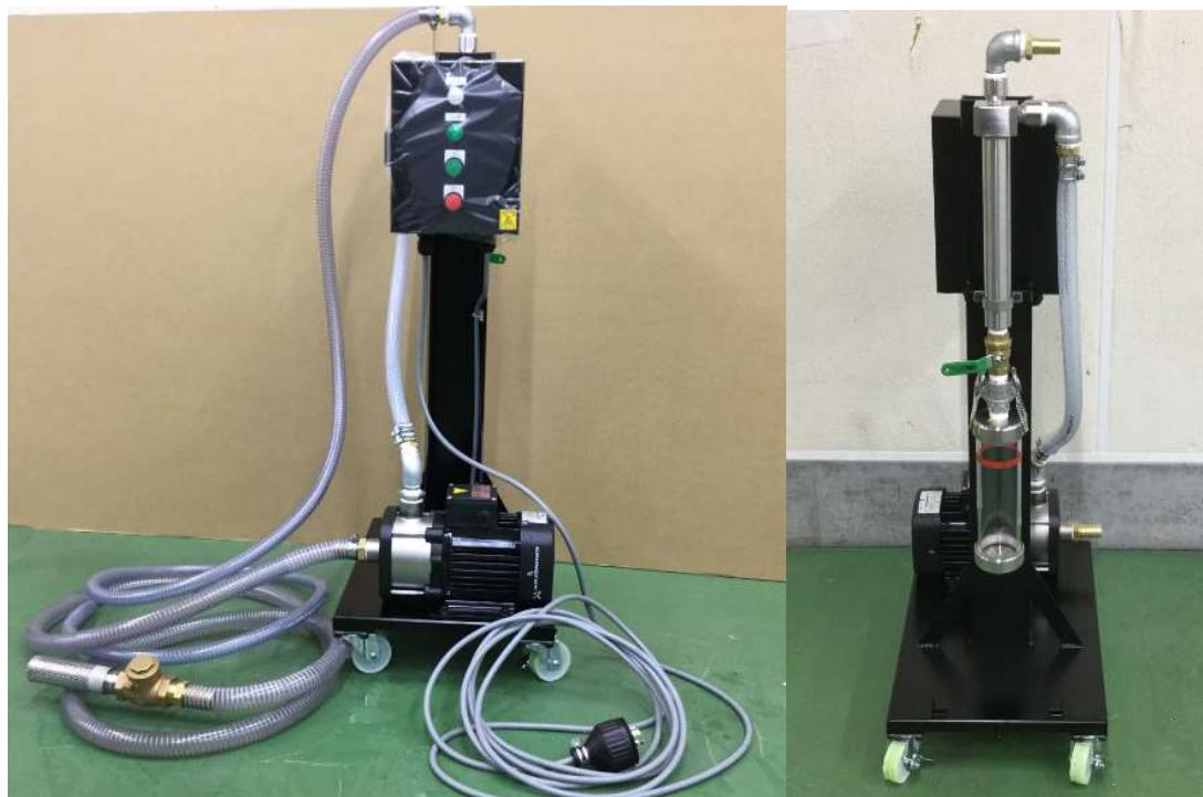
**D switch 沈殿物検出スイッチ**
